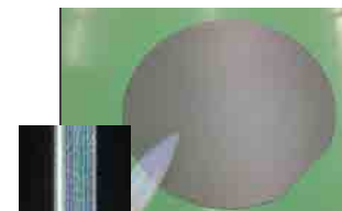
SiC、GaN 等、化合物ウェハ面取り 鏡面面取りも可能。研削面粗さ Ra20 nm 以下
